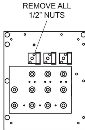
LINK BOARD ATTACHED IN 480 VOLT 3Ø POSITION
