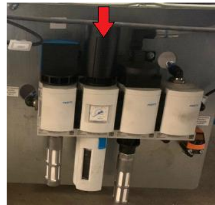
Abbildung 5.10 Reduzierventil des Skate systems
