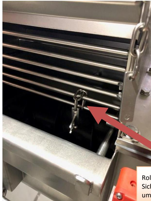
Rollen Sie die Kette mit dem Sicherheitsschlüssel auf diese Weise, um zu verhindern, dass sie während der Produktion in den Teig fällt
