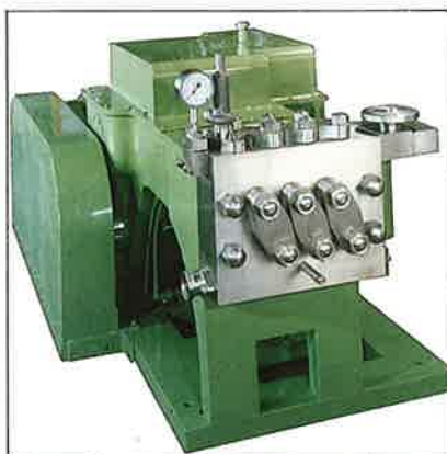
Hochdruckpumpe Typ MCP 15, 210 bar, 1000 bis 5000 l/h regelbar
