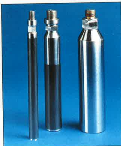
Zylinderblock für aseptischen Betrieb mit zusätzlicher Sperrwasserabdichtung
