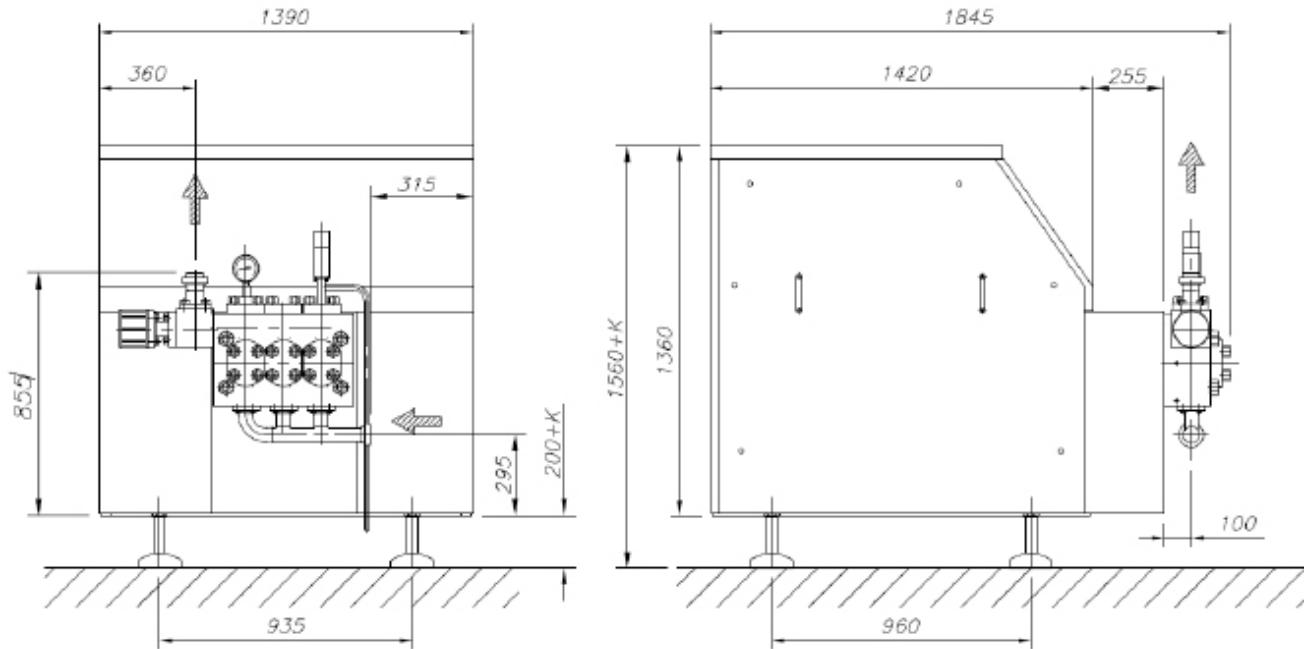
Die Baureihe Ariete ist für CIP- und SIP-Betrieb und Homogenisierdrücke bis zu 1500 bar geeignet. Alle Modelle können in ferngesteuerte Systeme und komplexe Prozesslinien integriert werden. Sie sind sowohl in sanitärer als auch in aseptischer Ausführung verfügbar. Durch breit gefächerte Auswahl an Materialien, niedrige Drehzahlen und lineare Kolbengeschwindigkeit können Ariete-Maschinen auch für abrasive und viskose Produkte eingesetzt werden.
