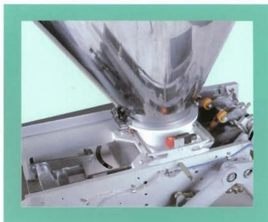
Coltello di taglio, pistone di pressata e pistoni di pesatura in posizione di estrazione per pulizia
