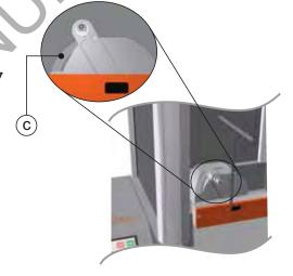
交換しないまま使用回数が15,000回に達すると、消耗プレートを交換するようにというメッセージが表示されます。消耗プレートを交換するまでは、試験機の電源を入れるたびにこの表示が続きます。
