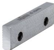
Referencia 163225 Mordaza normal finamente a cuadros SGNf, reversible, para aumentar la presión de contacto específica (mayores fuerzas de sujeción), un lado finamente a cuadros, un lado ranurado longitudinalmente.
