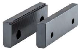
Ref. 166520 Mordazas de garra con paso fino, profundidad de sujeción de 2,5 mm.
