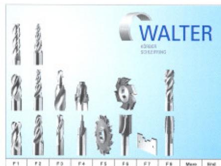
Startmaske „Werkzeugschleifen“ – Über die Funktionstasten F1 bis Fx wird das gewünschte Programm gewählt. Beispielsweise P1 „Zylindrische Fräser“, P3 „Bohrer und Stufenbohrer“, etc.
