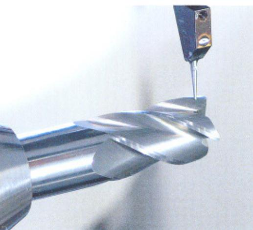
Das automatische Mess- und Positioniersystem Heli-Probe ist bei der Helitronic Basic Standard. Er führt die radiale und axiale Positionierung des Werkzeuges aus. Je nach Schleifprogramm übernimmt Heli-Probe verschiedene Messaufgaben wie Durchmesser, Teilung, Spiralsteigung, Schneidenlänge.
