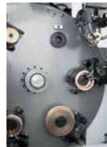
Werkzeugmagazin mit 6 Plätzen für Erodier- und Schleifscheiben
