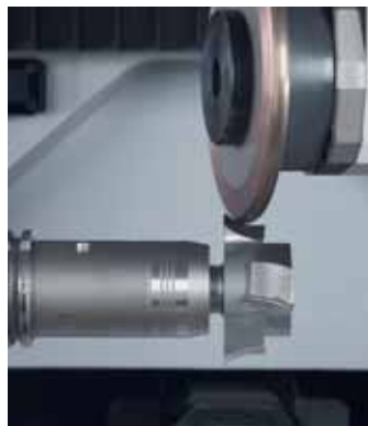
Erodieren eines Profilfräasers mit der Umfangscheibe
