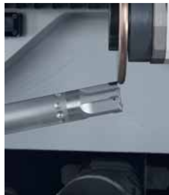
Erodieren einer Reibahle
