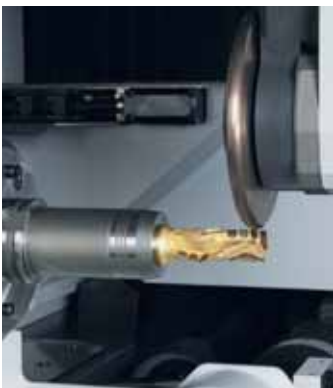
Erodieren eines Oberfräasers mit einer Umfangscheibe
