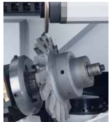
Erodieren eines Abplattfräasers
