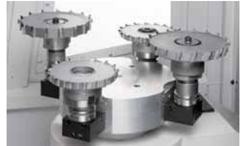
Magazin mit 4 Plätzen für große Werkstücke wie Scheibenfräser (das Magazin kann als Doppelmagazin ausgeführt werden, 8 Plätze)
