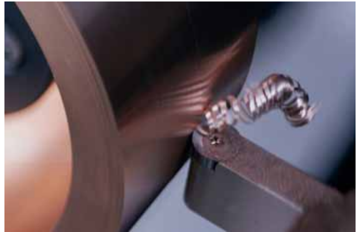
Abrichten einer Erodierscheibe
