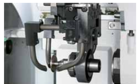
Erodierscheibe mit Spannkonus HSK 63F und Zuführeinrichtung für das Dielektrikum
