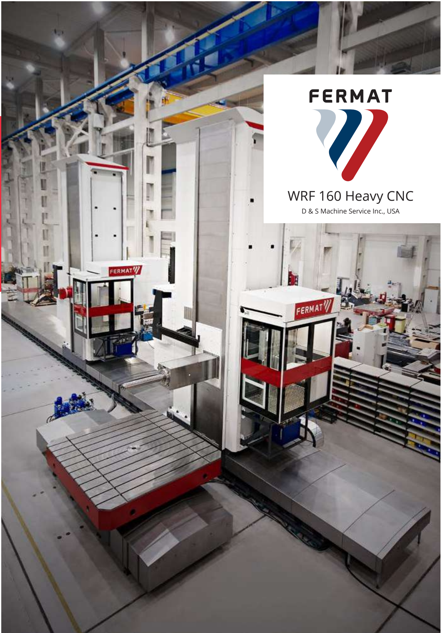
Parametri machina: X = 27000 mm, Y = 5000 mm, Z = 1500 mm, W = 1000 mm, Tavola girevole T 50, 3500 x 3 500 mm, CTS =20 ATC=60, UHAmi30, PHA 37/2,5 st
