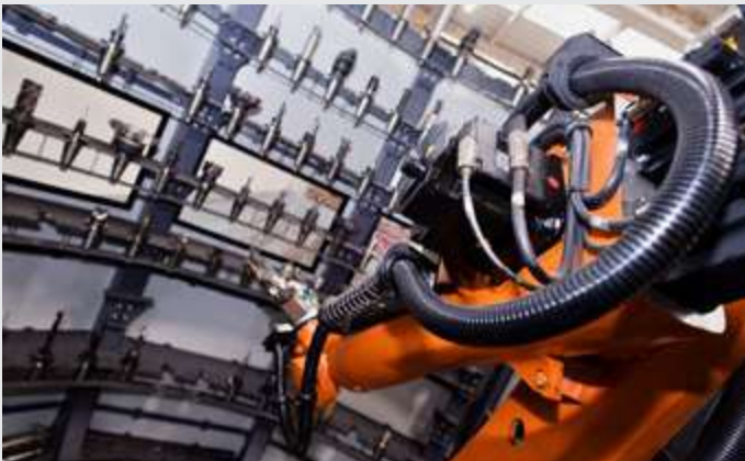
INTERNO DELL'ATC ROBOTIZZATO
