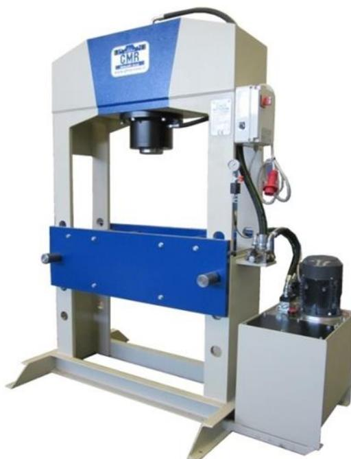
**Pressa oleodinamica a motore con doppia velocità e scambio automatico comando a leva con dispositivo di sicurezza bimanuale e di contemporaneità**
