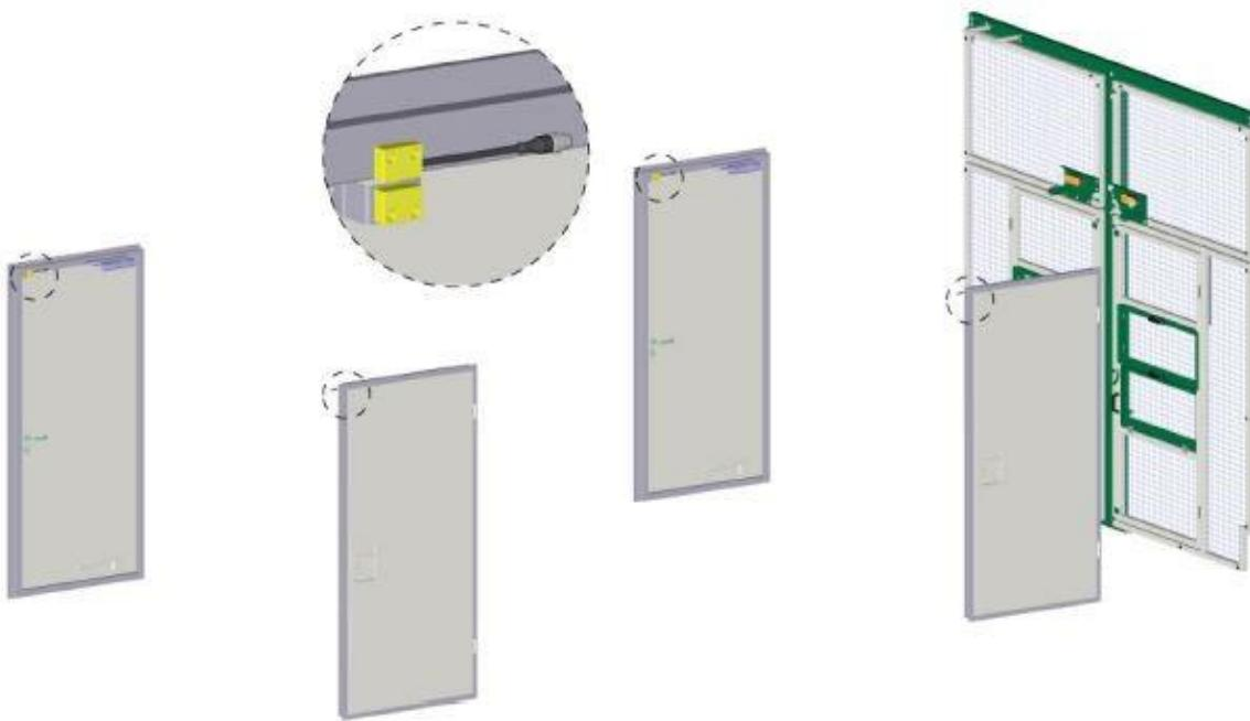
Die vier Zugangstüren vom Außenbereich in Richtung Schweißplatz sind mittels Magnetschalter gegen unbefugtes Betreten gesichert.
