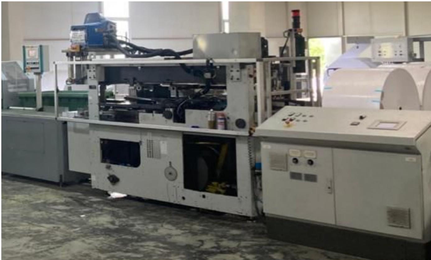
El sistema de fusión en caliente es Nordson Proglue 4 (tanque de 4 litros) con todas las mangueras y cabezales originales de Nordson.
