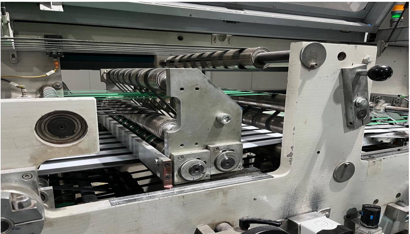
El conteo se realiza mediante la rotación del cortador transversal y sensores. Por eso es casi imposible cometer errores al contar con el procedimiento operativo adecuado.
