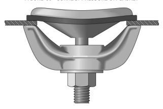
FIGURE 81 - OVERCOMPRESSED GASKET
