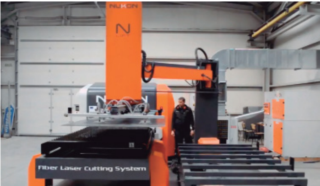
Braccio caricatore N-lift - 76° (alimentazione di una attrezzatura)
