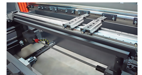
Battuta posteriore con controllo CNC a 2 assi (X e R)
