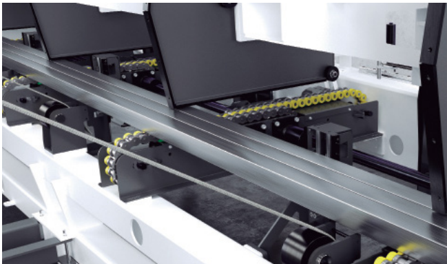
Sistema di carico profili automatico
