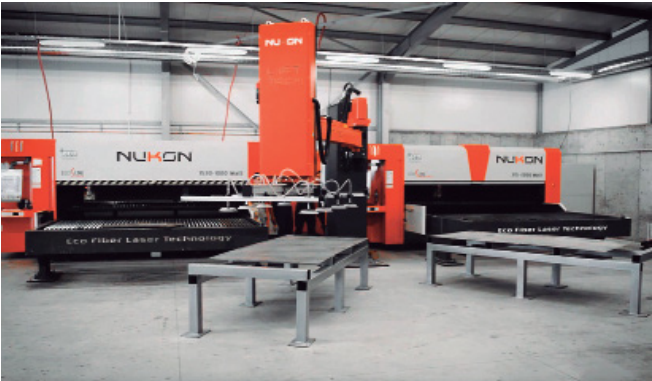
Braccio caricatore Lift Tech 180° (alimentazione di due attrezzature)
