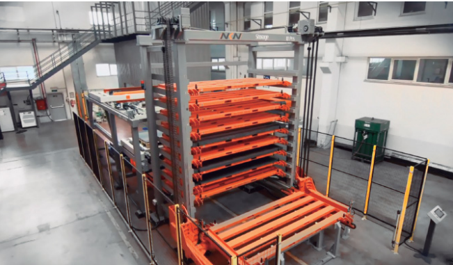
Sistema di stoccaggio tipo torre e scarico di pezzi
