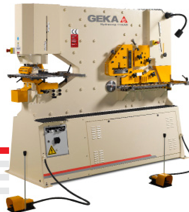
Série Hydracrop 2 cilindri 5 stazioni di lavoro
