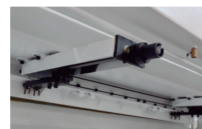
Battuta posteriore con encoder e mandrino
