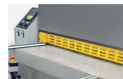
Barriera frontale di sicurezza
