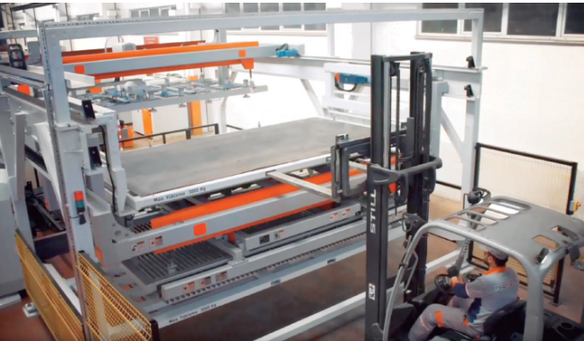
Compact lift con carico e scarico per lamiera fino a 900 kg
