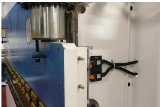
regolazione punto morto superiore e regolazione rallentamento esclusione barriere di sicurezza
