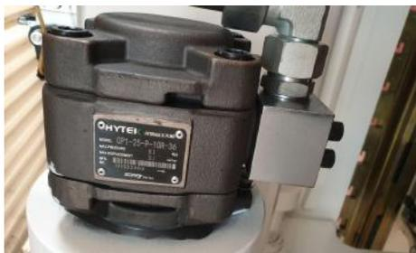
Pompa oleodinamica e tubi oleodinamici rigidi
