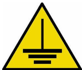
Schließen Sie die Maschine an das Erdungssystem mithilfe eines Kupferdrahtes mit dem geeigneten Querschnitt an.
