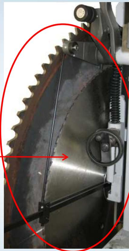
Bei allen Teilscheiben müssen Sägen-Durchmesser und Zähnezahl bei Bestellung definiert werden, es sind auftragsbezogene Sonderanfertigungen.
