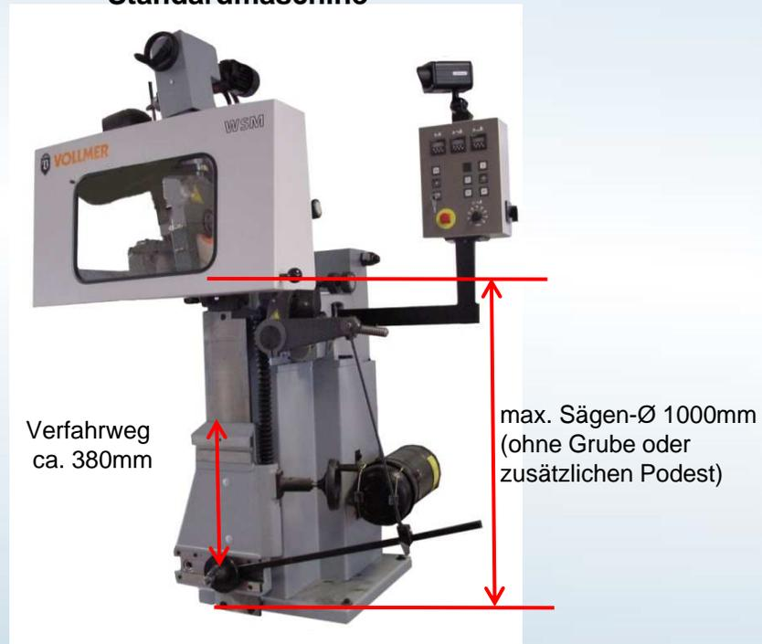
**Maschine mit Sockel und Führungslager Zb175**
