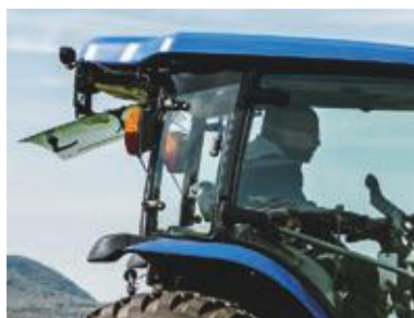
ACHTERRUIT EN ZIJRUITEN VAN DE CABINE KUNNEN WORDEN OPENGEKLAPT
