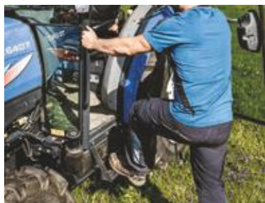
OPSTAP BIJ DE VERSIES MET CABINE EN MET VEILIGHEIDSBEGEL
