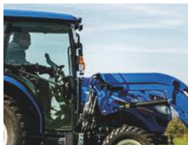
FRONTLADER MET OF ZONDER PARALLEL- LOGRAM VOOR ALLE MODELLEN LEVER- BAAR
