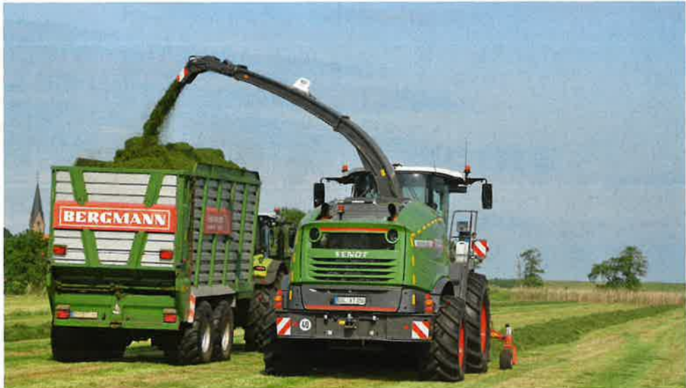
De blaaspomp is verder verbeterd. Dat wil zeggen een grotere diameter en een grotere reikwijdte. De grote service- kleppen hadden we gelukkig niet nodig. Ook niet in suikerrijk gras.
