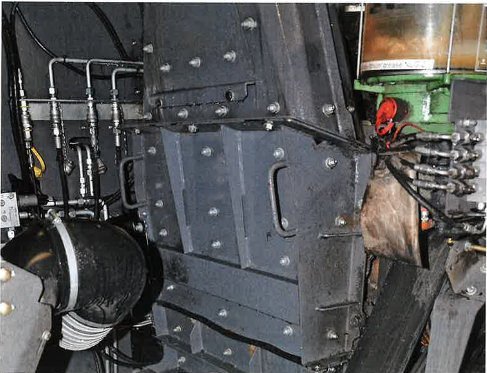
De in dit geval 300 millimeter grote R-Cracker-korrelkneuzer met 148 tanden en 30% toerentalverschil verkleint de maiskorrels, zoals je mag verwachten. Er is ook een RS-Cracker met V-vormige groeven.
