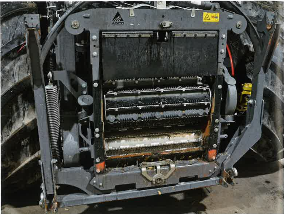
In vergelijking met z'n voorganger, de Katana 85, is de invoer zijdelings duidelijk beter afgedicht. Er zijn zes voor- perswalsen en wij werkten met een messentrommel met 28 messen in gras en 40 messen in mais. Dat geeft snij- lengtes van respectievelijk 3,7 tot 20,7 en 2,6 tot 14,5 millimeter.
