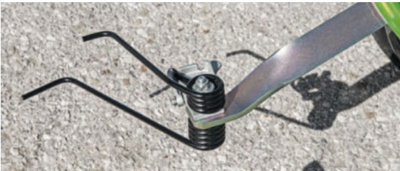
Door de speciale tandbevestiging met veranderbare aanzethoek kan de machine eenvoudig worden omgesteld op kantschudden of nachtzwaden en is de machine tegelijkertijd beschermd tegen verlies van tanden.
