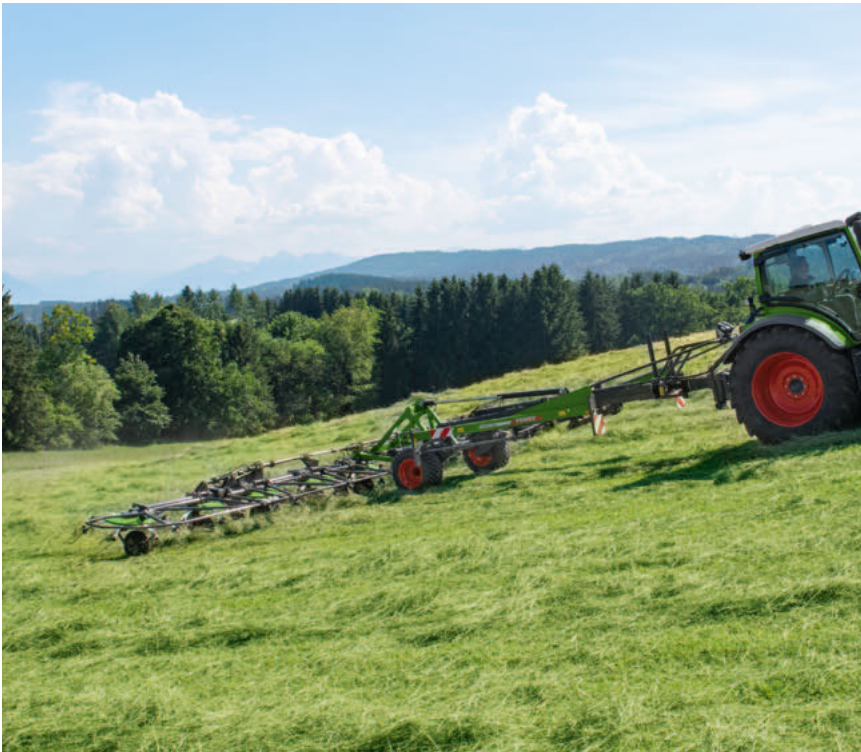
Over de gehele werkbreedte verdeeld bevinden zich tussen de rotors meerdere scharnierpunten. Daardoor kan elke rotor zich aan de bodem aanpassen. Dit zorgt er ook voor dat de slijtage gering is en het gewas schoon blijft.
