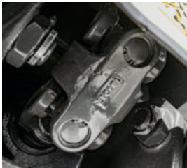
Dankzij de onderhoudsvrije dubbele kruiskoppelingen is er een rechtstreekse krachtoverbrenging en kan de schudder ook in opgeklapte transportstand soepel draaien.
