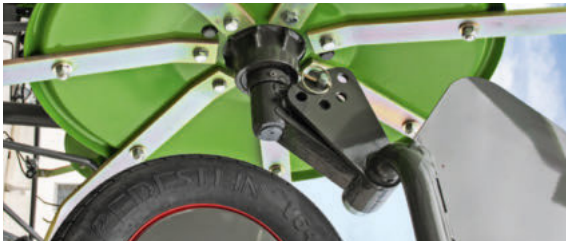
De schudhoek wordt eenvoudig ingesteld door een bout te verzetten. Er zijn 5 posities mogelijk, van 10° tot 17°. Zo kunt u de schudhoek steeds aan de omstandigheden aanpassen.
