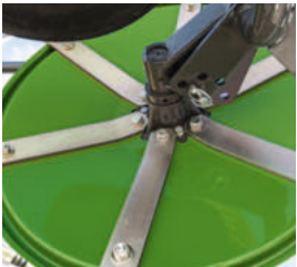
Door de grote diameter van de rotorschotels hebben de tanden ondanks het lage rotortoerental een hoge snelheid.
