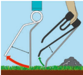
De slepend gemonteerde Fendt Performance-tanden kunnen door hun grote flexibiliteit veel gemakkelijker uitwijken voor obstakels dan reguliere tanden. Daardoor is tandbreuk bij de Lotus niet aan de orde.
