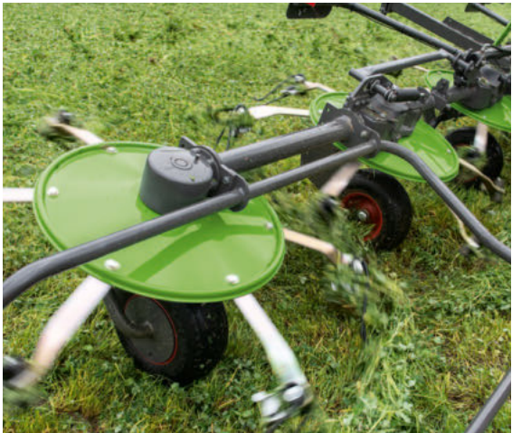
Doordat zich dikke banden onder elke rotor bevinden, wordt het gewas zeer goed opgepakt en past de machine zich prima aan de bodem aan.
