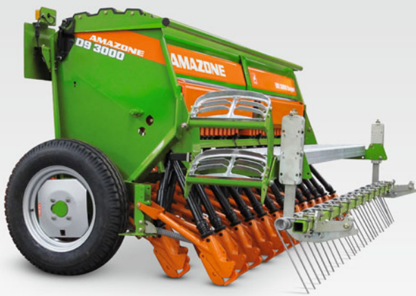
De aanbouwzaamachine D9 3000 met WS-sleepkouter voor het solo zaaien
