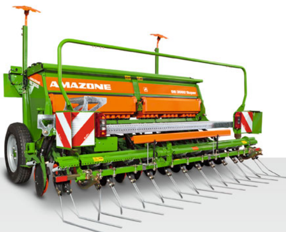
D9 3000 Super met 3 m werkbreedte en de RoTeC-Control enkele schijfkouter
