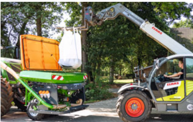
Grote trechteropening van 1,1 m x 2,2 m voor snel en eenvoudig vullen van de FTender
