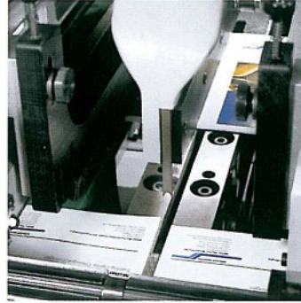
Schneiden Einfach- und Doppelnutzen
