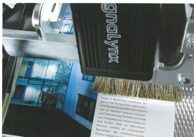
▲ Sistema di riconoscimento delle segnature ›Signalynx‹ per l'ispezione di segnature
