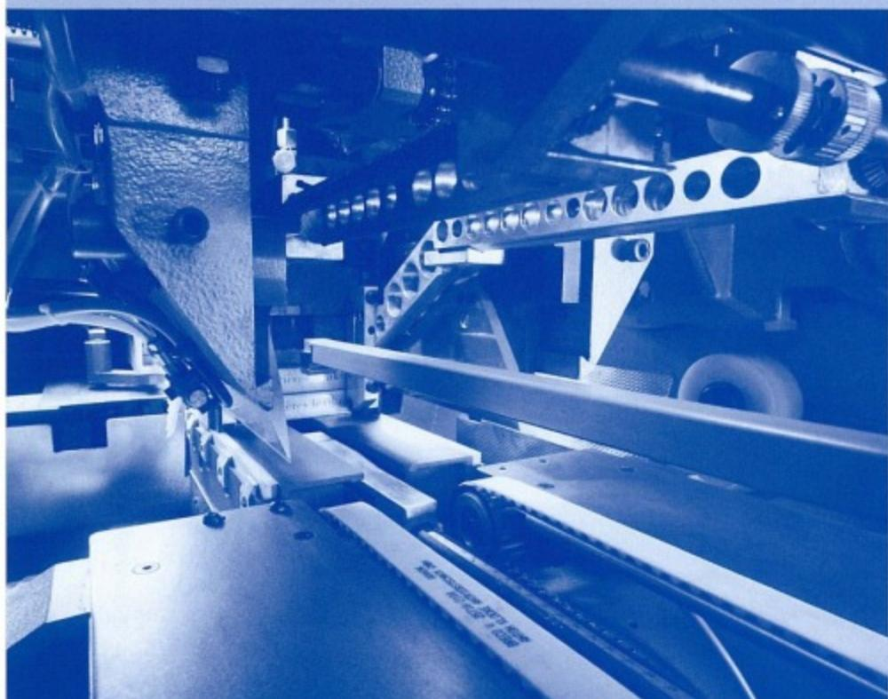
Für das dreiseitige Beschneiden von Buchblocks und Broschuren, zum Einsatz als Einzelmaschine oder in Fertigungsstraßen
