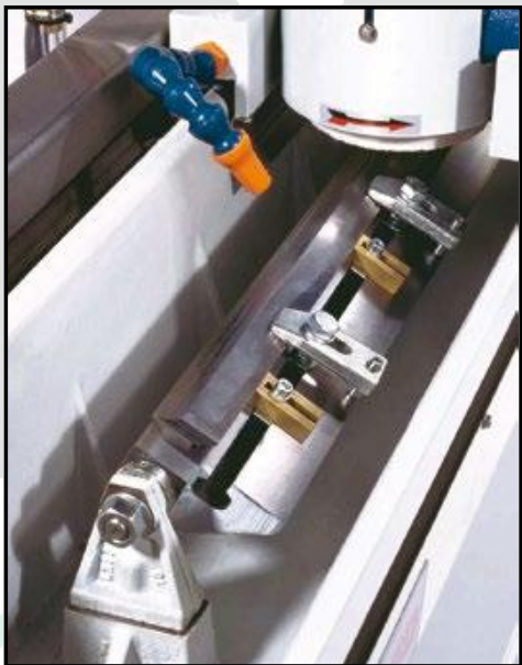
Kit serraggio coltelli da pialla Kit for sharpening planer knives Klemmsystem für das gleichzeitige Schleifen von 4 Hobelmesser
