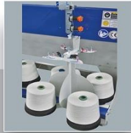
Çatlık grubu ve BTSR sensör sistemi Creel group and BTSR sensor system
