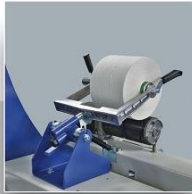
Bobin Yoğunluğu Ayar Ünitesi Bobin Density Setting Unit
