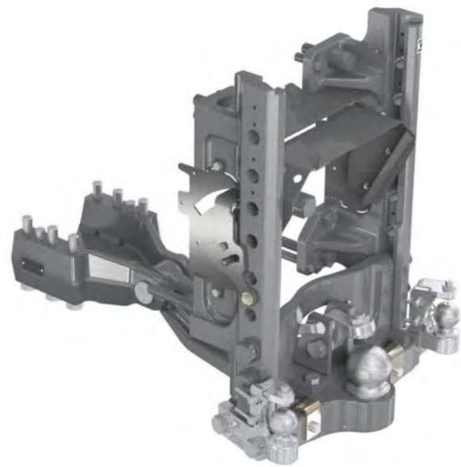
Accoppiamento a testa sferica corto (con/senza punti di attacco sterzo forzato)
