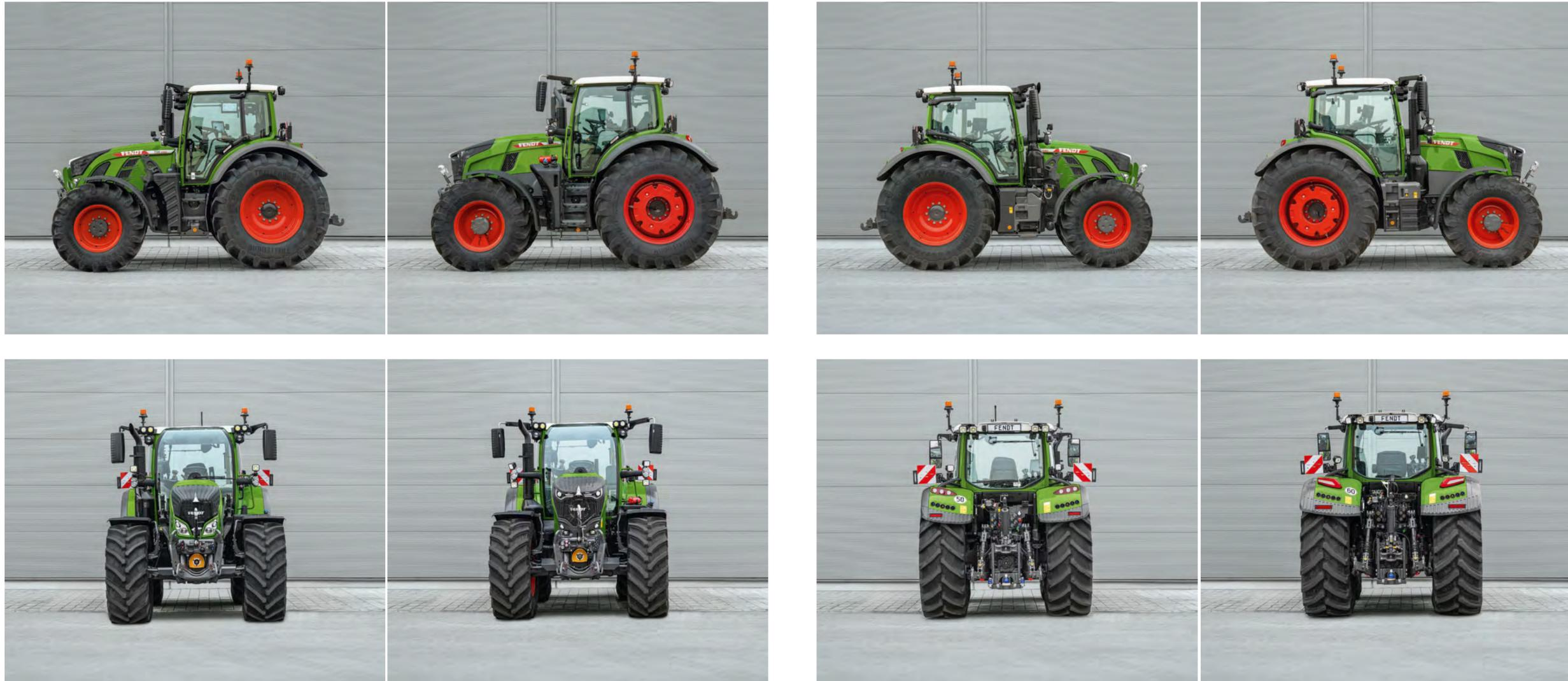
Fendt 724 Vario Gen6: pneumatici anteriori – 600/65 R28; pneumatici posteriori – 650/75 R38 (diametro di 1,95 m)
