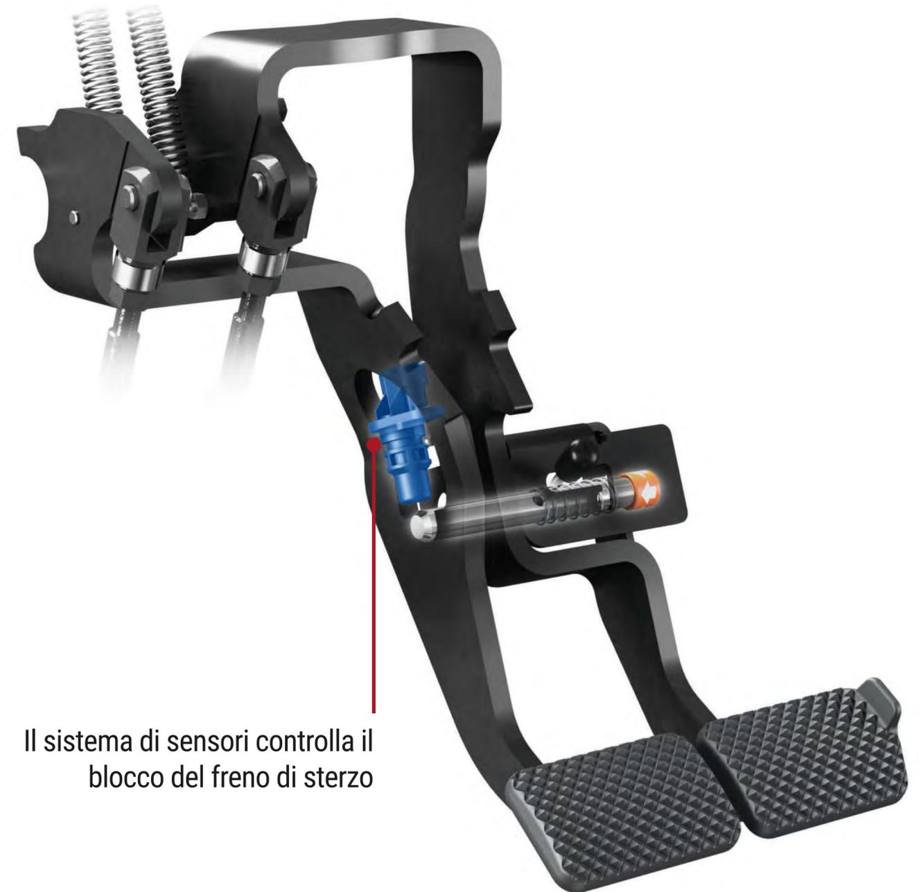
Il sistema di sensori controlla il blocco del freno di sterzo
