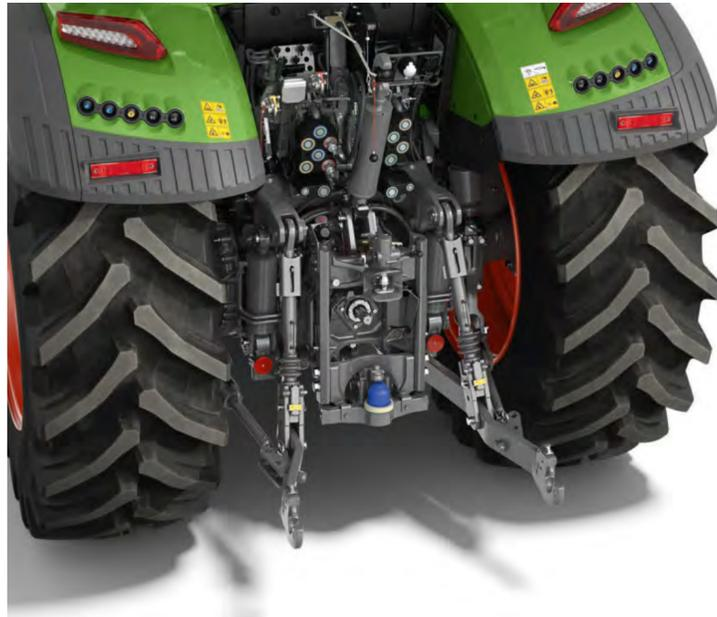
Sollevatore posteriore con attacchi rapidi e stabilizzatori laterali (UE)
