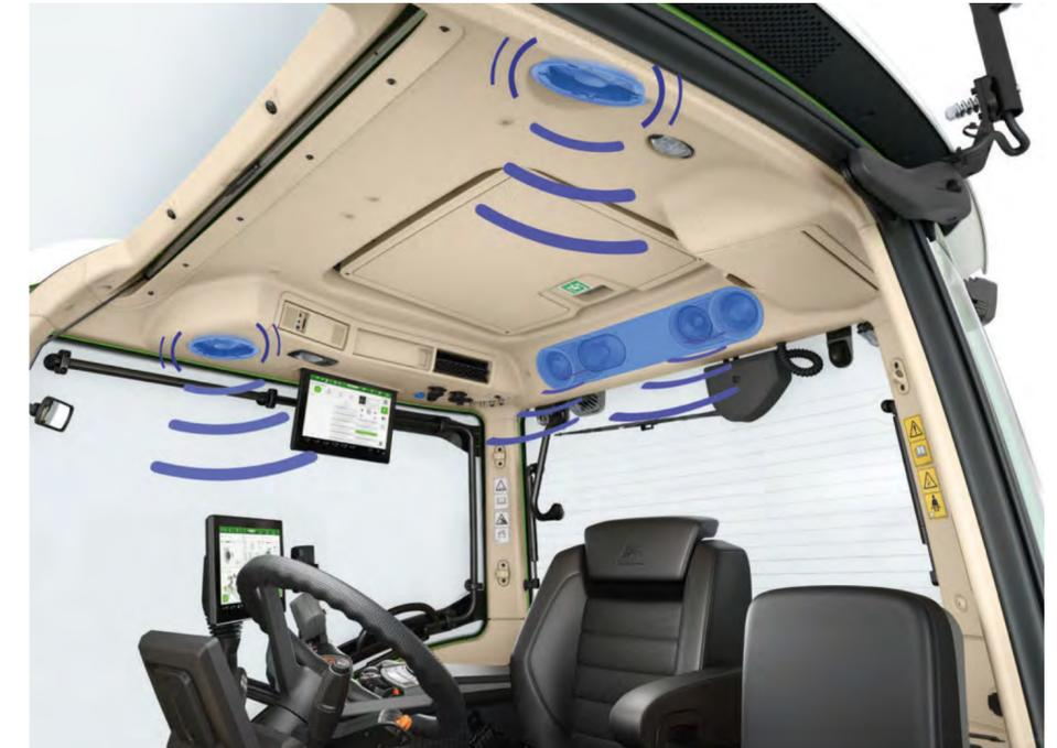
Connessione di sorgenti audio esterne tramite Bluetooth o via cavo utilizzando un attacco USB e/o AUX-IN
