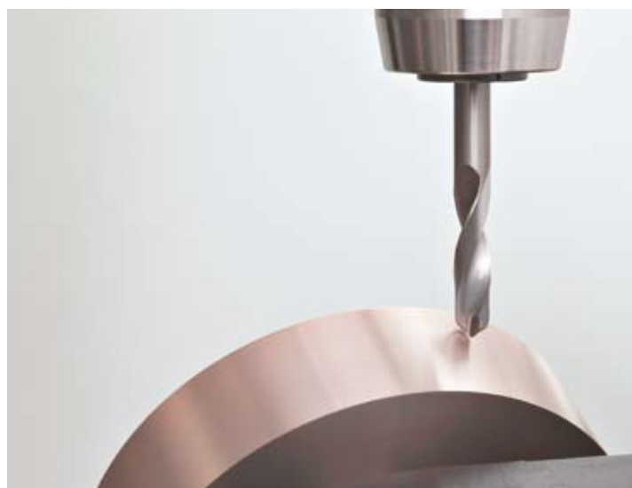
Erodieren der Hauptschneide eines PKD-Bohrers mit dem neuen Softwarepaket – kein Problem.
