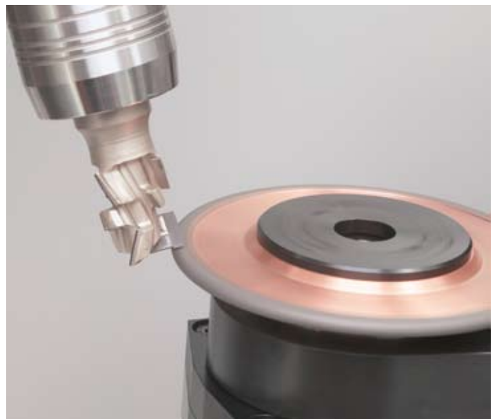
Freischleifen eines Schaftfräfers an der Stirn.
