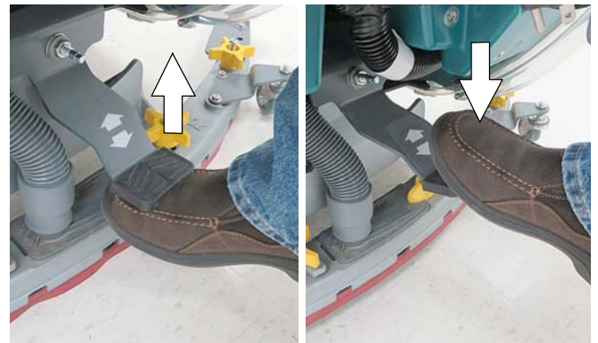
1er passage - lamelle relevée 2nd passage - lamelle baissée
