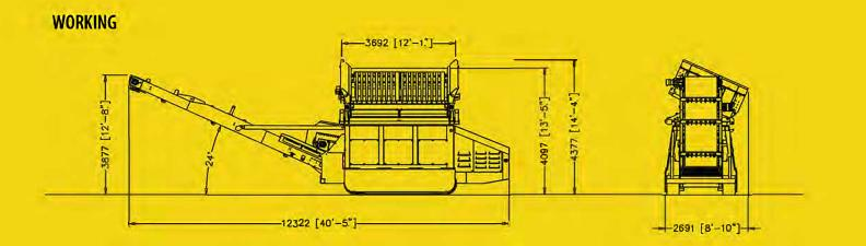
THE FSL100 IS IDEAL FOR SCALPING ROCK AS A PRE SCREEN FOR CRUSHING OR FOR SCREENING OUT SINGLE SIZES WHEN REQUIRED.
