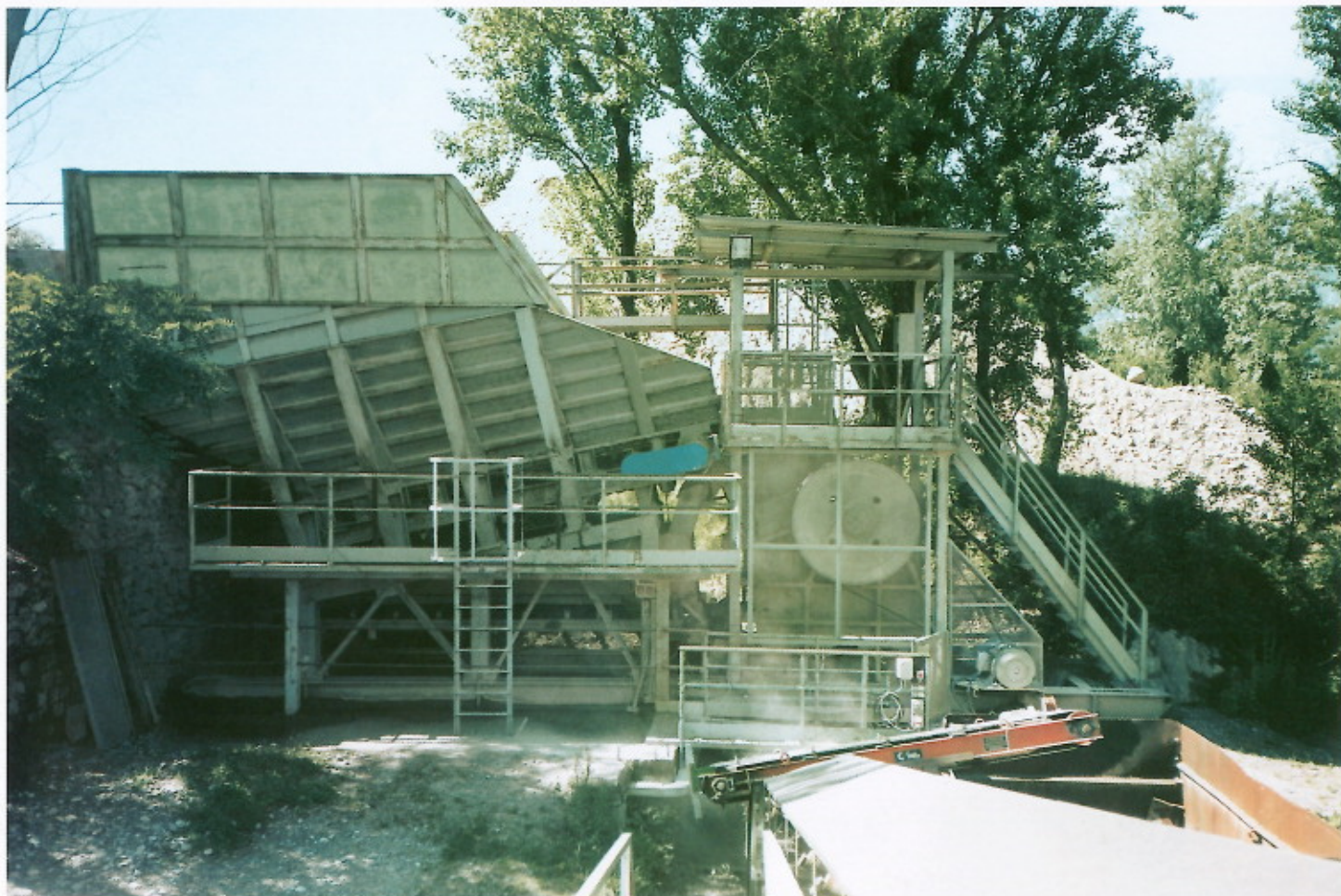
Alimentatore "AC.88" con frantoio "90.K". "AC.88" type feeder and "90.K" jaw crusher. Alimentateur "AC.88" et concasseur "90.K".
