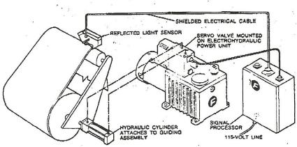
PHOTOELECTRIC-HYDRAULIC GUIDING SYSTEM
